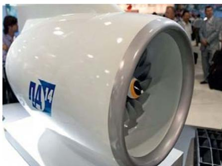
ный двигатель – сложнейшее инженерное устройство, требующее очень непростых конструкторских решений. Например, одна лопатка турбины, а их в ступенях насчитывается около 70, вращается с частотой 12 тысяч оборотов в минуту, и на нее действу-
