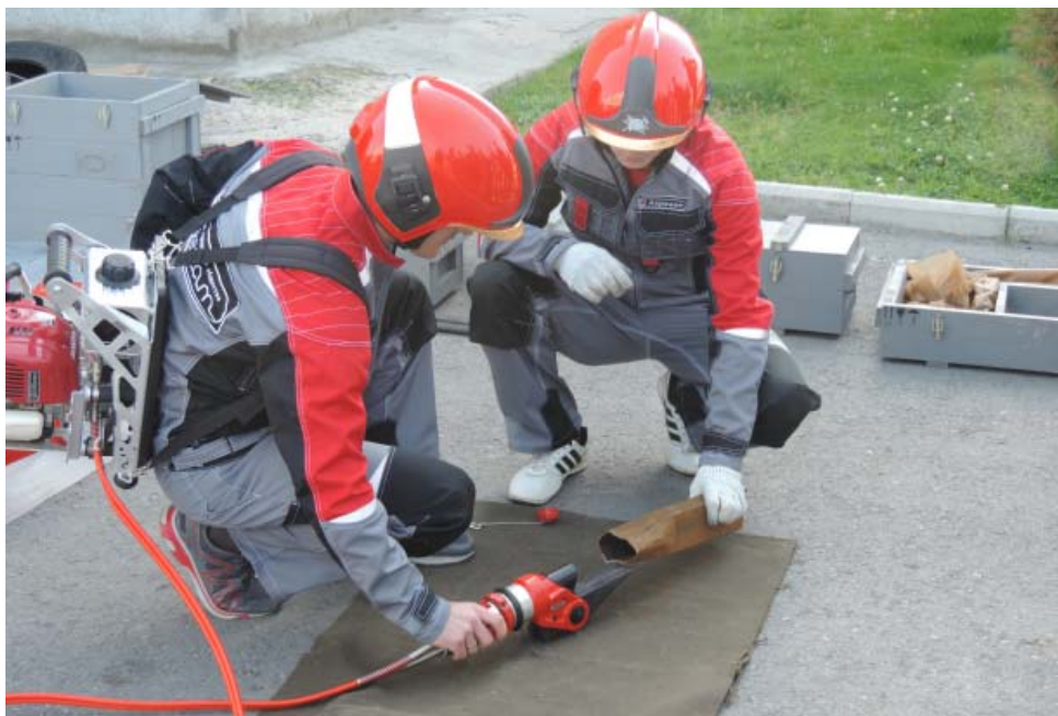
Испытатели Иван Анкундинов и Денис Головки демонстрируют работу мини-расширителя дверного МРД-С4 и ранцевой станции СНР-С4
